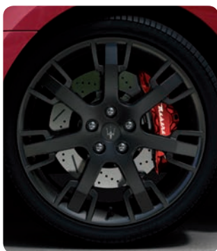
Jantes alliage 20 pouces avec dessin Neptune Grigio Mercury (8,5J x 20" avant; 10,5J x 20" arrière)
