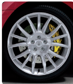
Jantes alliage 20 pouces avec dessin Trident Silver (8,5J x 20" avant; 10,5J x 20" arrière)
