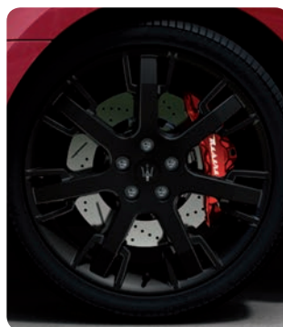
Jantes alliage 20 pouces avec dessin Neptune Nero (8,5J x 20" avant; 10,5J x 20" arrière)
